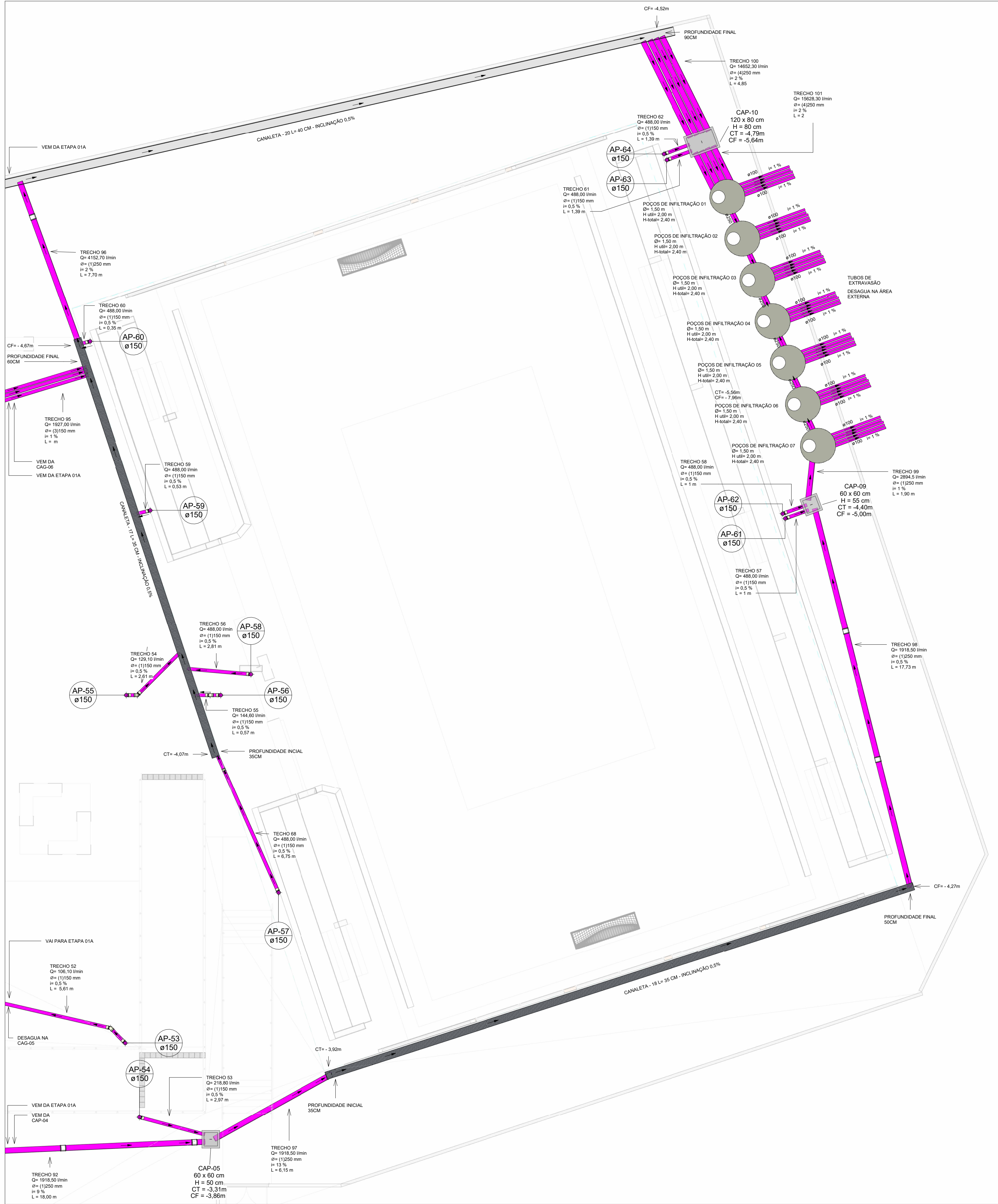
PLANTA BAIXA DRENAGEM PLUVIAL - TÉRREO ETAPA 01 B Escala 1 : 100
